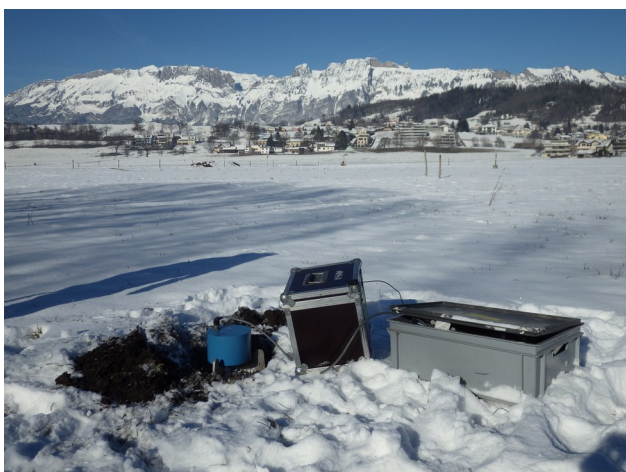
Měřicí aparatura – modrý válec je sensor pohybu půdy, v šedé bedně je zařízení které signál digitalizuje a ukládá, na hnědé bedně je anténa GPS, kterou se synchronizuje čas
